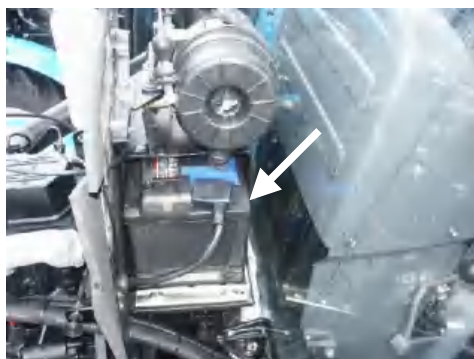
Rys. F-80. Umieszczenie akumulatora
