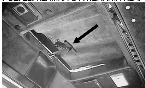
Rys. C-24 Klamka otwierania klapy dachu kabiny.
