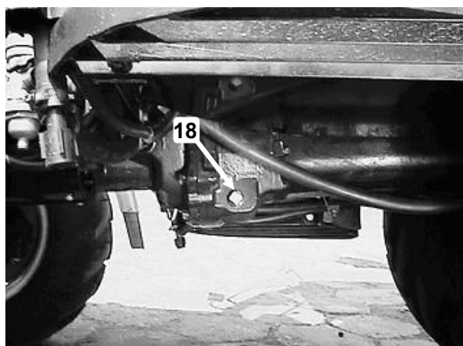
Rys. E-13 Położenie korka spustowego skrzyni przekładniowej (18).
