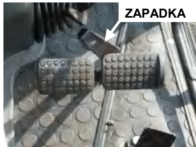
Rys. F-28. Połączyć pedały hamulca zapadką przed włączeniem „blokady”.
