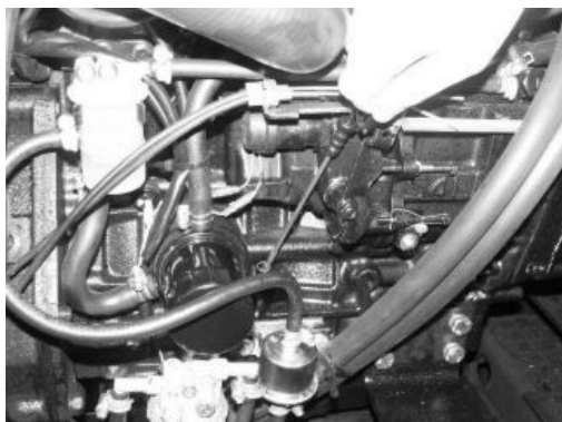
Rys. E-5 Wskaźnik prętowy poziomu oleju. Położony jest z prawej strony ciągnika. Poziom oleju utrzymać między wycięciami L - H.
