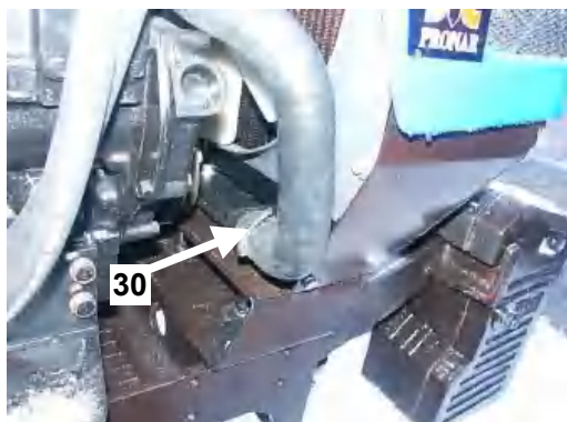
Rys. E-24 Miejsce spuszczenia płynu chłodzącego z chłodnicy (30).
