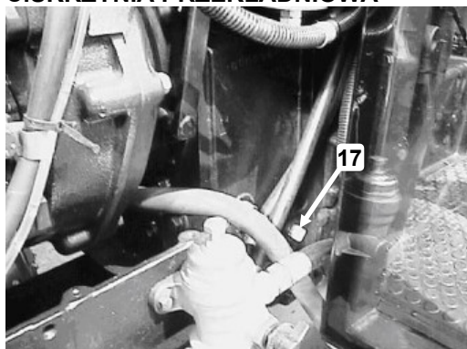
Rys. E-12 Położenie korka wlewowo - kontrolnego skrzyni przekładniowej (17).
