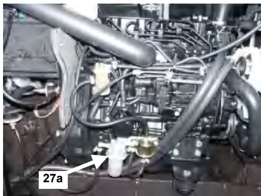
Rys. E-21a Zawór odstoju paliwa (27a).
