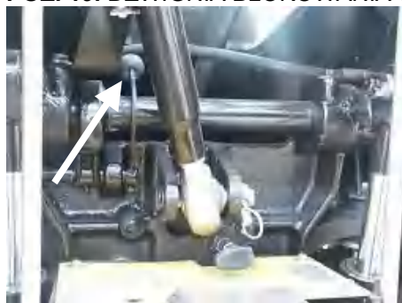
Rys. C-21 Dźwignia blokowania wału TUZ .
