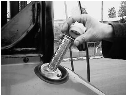
Rys. E-18 Korek wlewu oleju układu hydrauliki i kierowniczego wraz z filtrem wlewowym.
