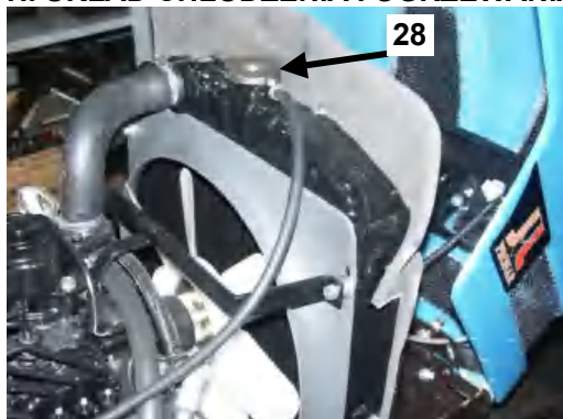
Rys. E-22 Położenie korka chłodnicy (28).
