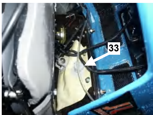
Rys. E-27 Zbiornik płynu spryskiwacza szyby (33).
