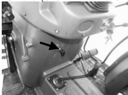
Rys. C-14 Cięgło sterowania reduktorem skrzyni biegów i piktogram.
