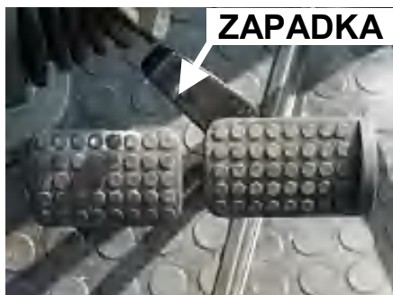
Rys. C-16 Pedały sterowania hamulcami roboczymi.
