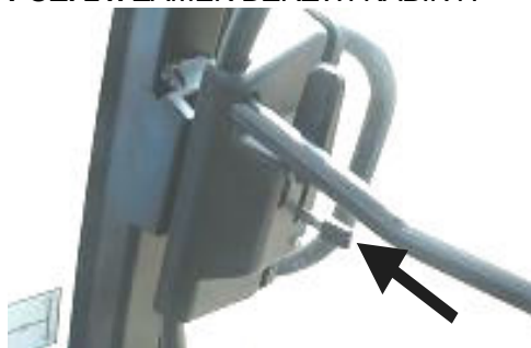
Rys. C-23 Zamek drzwi kabiny .
