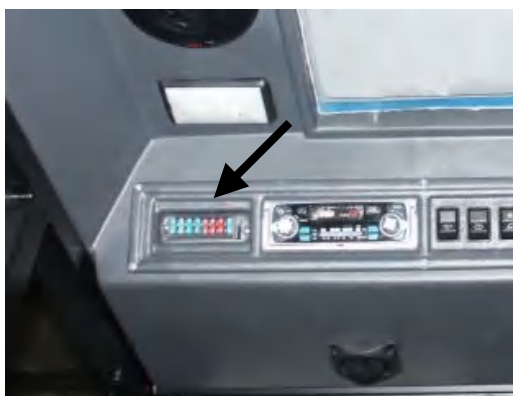
Rys. F-90 Schemat i opis bezpieczników umiejscowionych w konsoli.
