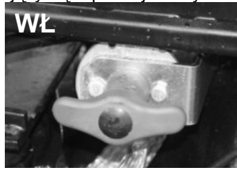
Rys.D-1 Położenia włącznika „masy”
