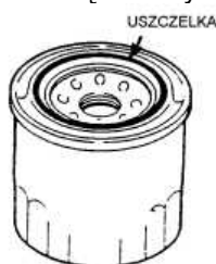
Rys. F-2. Filtr oleju i pierścień uszczelniający.
