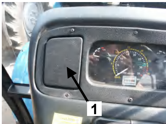
Rys. F-89 Umiejscowienie bezpieczników w konsoli. 1- osłona; 2- skrzynka bezpieczników; 3- przekaźniki; 4- bezpiecznik wysokoprądowy 50A
